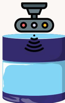
Esempio: Serbatoio da 1000 litri, altezza massima raggiungibile dall'acqua (stop riempimento grazie al galleggiante) 1.90m, distanza tra posizionamento del sensore e livello massimo acqua 20 cm.
