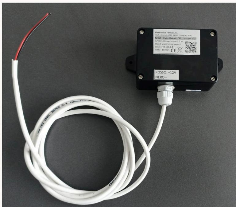
Il Cavo di alimentazione a 12VDC è lungo 2m e va connesso ad alimentatore AC/DC 12V mini 12-4W da noi fornito, fare attenzione alla polarità:
